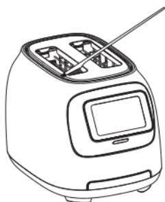
Utilizzare lo strumento di pulizia fornito da Tineco per pulire le briciole rimaste nel tostapane. Non utilizzare strumenti affilati che potrebbero danneggiare l'apparecchio. Scollegare il tostapane, capovolgerlo e agitarlo delicatamente per rimuovere eventuali residui di briciole.
