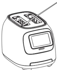
Verwenden Sie das von Tineco mitgelieferte Reinigungswerkzeug, um die im Toaster verbliebenen Brotkrumen zu entfernen. Verwenden Sie keine scharfen Utensilien, die das Gerät beschädigen könnten. Ziehen Sie den Netzstecker, drehen Sie den Toaster auf den Kopf und schütteln Sie ihn vorsichtig, um verbliebene Brotkrumen zu entfernen.
