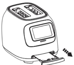
Um die Brotkrumen im Toaster zu entfernen, ziehen Sie die Krümelschublade heraus. Setzen Sie die Krümelschublade wieder ein, indem Sie sie nach hineinschieben, bis sie einrastet. Leeren Sie die Krümelschublade, bevor Sie den Toaster erneut benutzen.
