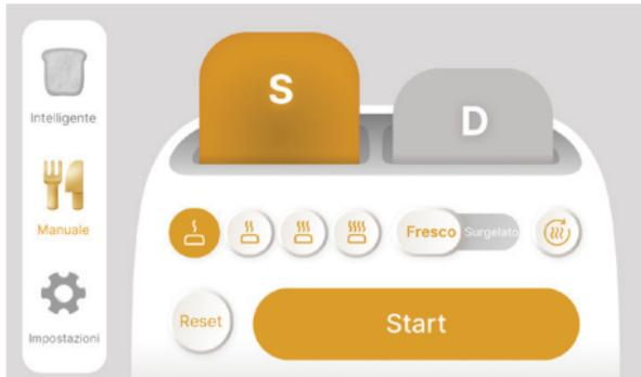
Posizionare il cibo nelle fessure, selezionare le funzioni di tostatura e il livello di tostatura desiderati.
