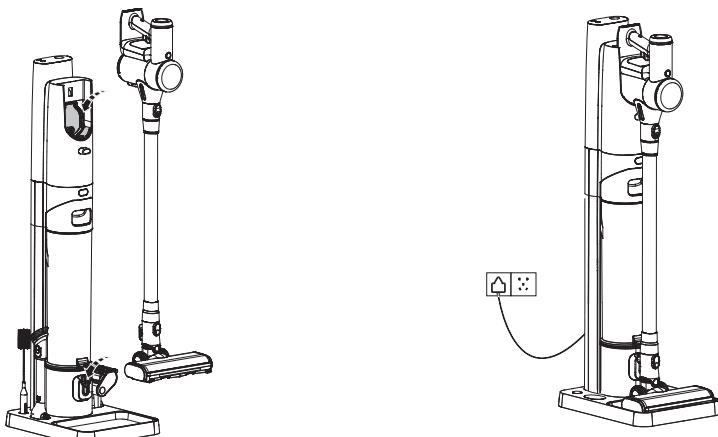
Placez l'aspirateur sur la station de nettoyage. La station de nettoyage commencera alors à se recharger et le nettoyage automatique sera également activé.
