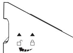
Drehen Sie die obere Abdeckung gegen den Uhrzeigersinn, um sie zu öffnen, und entfernen Sie dann die Filterwatte und das Filterelement.
