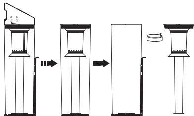
Gire en sentido antihorario para abrir la tapa superior y retire el algodón del filtro y el elemento de filtro.
