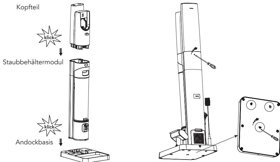
Setzen Sie zuerst das Staubbehältermodul in die Andockbasis und dann das Kopfteil in das Staubbehältermodul ein.
