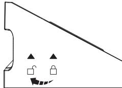
Ruotare in senso antiorario per aprire il coperchio superiore, quindi rimuovere il cotone filtrante e l'elemento filtro.
