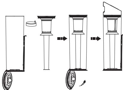
Plaats na het reinigen het gaasfilter en de stofbak terug in het reinigingsstation.
