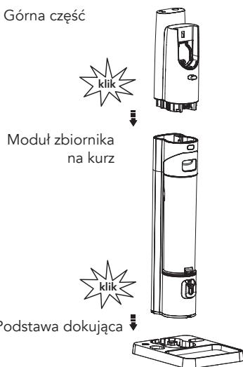
Najpierw włożyć moduł zbiornika na kurz do podstawy dokującą, a następnie górną część do zbiornika na kurz.
