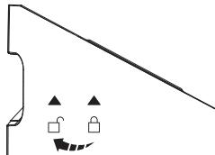
Przekręcić w kierunku przeciwnym do wskazówek zegara, by otworzyć górną pokrywę, a następnie usunąć filtr bawełniany i element filtra.
