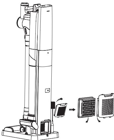
Wyciągnąć filtr HEPA do czyszczenia. Nie używać urządzenia, w którym nie ma filtra HEPA.
