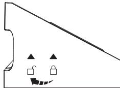
Tournez dans le sens antihoraire pour ouvrir le couvercle supérieur, puis retirez le coton filtrant et l'élément filtrant.
