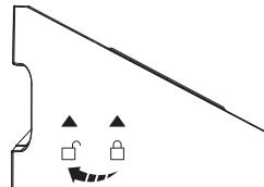
Üst kapağı açmak için saat yönünün tersine çevirin ve ardından filtre pamuğunu ve filtre elemanını çıkarın.
