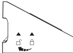
Draai tegen de klok in om het bovenste deksel te openen en verwijder vervolgens het filterkatoen en het filterelement.
