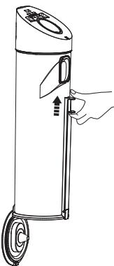
Drücken Sie die Verriegelung, um den Deckel zu öffnen und den Staubbehälter zu leeren.
