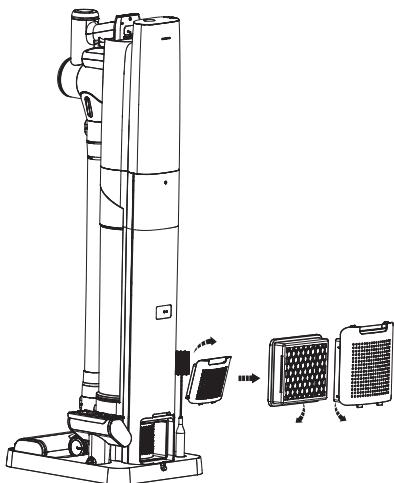
Trek het HEPA filter eruit om te reinigen.
