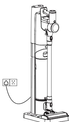
Süpürgeyi Temizleme İstasyonuna yerleştirin. Temizleme İstasyonu şarj olmaya başlar ve bu sırada kendi kendini temizleme de etkinleştirilir.
