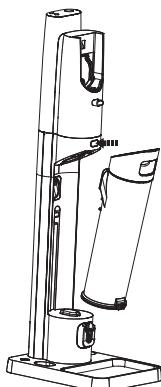
Drücken Sie die Entriegelungstaste und ziehen Sie den Staubbehälter heraus.
