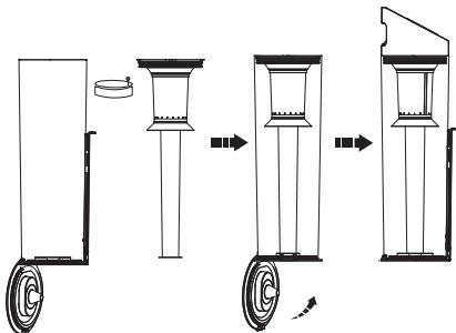
Después de limpiarlos, vuelva a instalar el filtro de malla y el depósito de polvo en la estación de limpieza.
