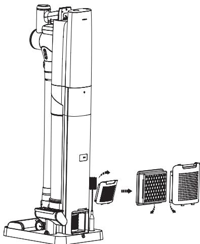
Ziehen Sie den HEPA-Filter zur Reinigung heraus. Nehmen Sie das Gerät nicht ohne zuvor eingesetzten HEPA-Filter in Betrieb.
