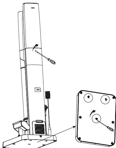
W przypadku, gdy stacja czyszcząca wymaga rozmontowania, nacisnąć zatrzask z narzędziem, by rozdzielić trzy elementy.
