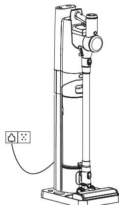
Stellen Sie den Staubsauger in die Reinigungsstation. Die Reinigungsstation beginnt dann mit dem Laden, während die Selbstreinigung ebenfalls aktiviert wird.
