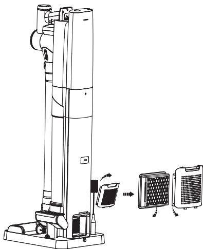
Estire del filtro HEPA para limpiarlo. No utilice el aparato sin instalar primero el filtro HEPA.
