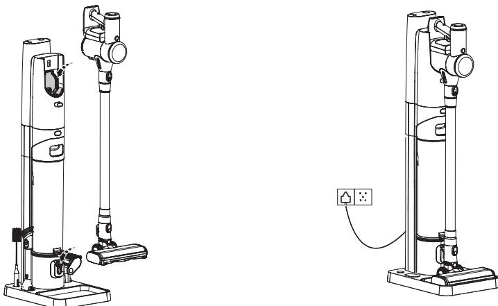
Plaats de stofzuiger op het reinigingsstation. Het reinigingsstation begint dan met opladen en ondertussen wordt ook de zelfreiniging geactiveerd.
