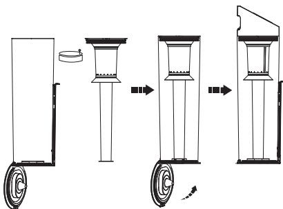
Po czyszczeniu zainstalować filtr siatkowy i zbiornik na kurz z powrotem w stacji czyszczącej.
