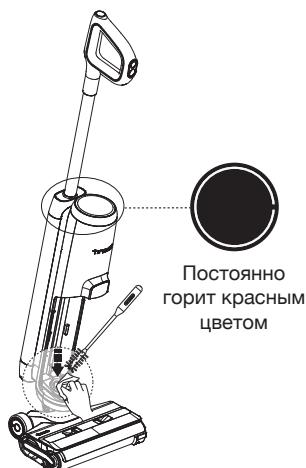
Если светодиодный контур горит красным цветом, снимите резервуар для грязной воды и очистите датчик загрязнений влажной тканью или инструментом для очистки.
