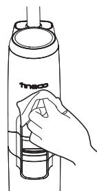
Для снижения риска травм отключайте устройство перед проведением технического обслуживания.
