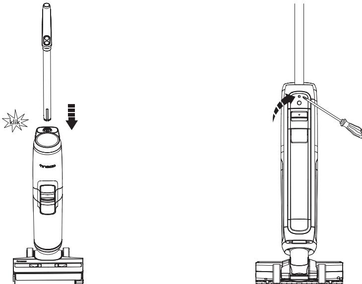
Om de handgreep te monteren, steekt u deze in het apparaat totdat u een klik hoort.
