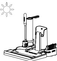
С помощью инструмента для очистки удалите волосы и мусор, скопившиеся вокруг щетки, и промойте ее водой. Поставьте роликовую щетку на подставку для аксессуаров и дайте ей полностью высохнуть перед установкой на место.
