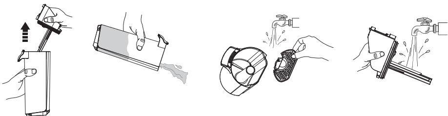
Si le couvercle du réservoir d'eau sale et le filtre à l'intérieur sont obstrués, retirez-les et rincez-les deux à l'eau.
