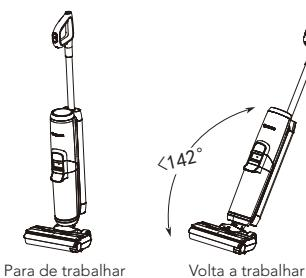
O aparelho para de trabalhar quando colocado numa posição vertical e volta a trabalhar quando reclinado.
