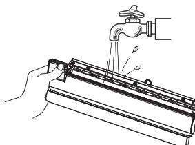
Промойте элемент водой.
