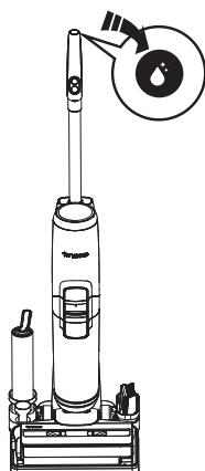
1. Coloque o aparelho na base de carregamento após a utilização, o sensor irá detetar automaticamente o nível de sujidade.
