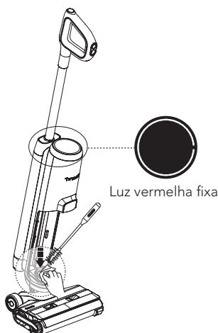
Quando o círculo de LED acende a vermelho, retire o depósito de água suja, limpe o sensor de sujidade com um pano húmido ou com a ferramenta de limpeza.
