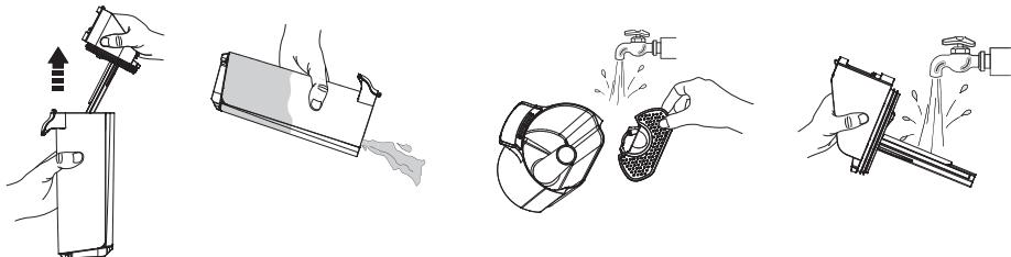
Если крышка резервуара для грязной воды и внутренней фильтр загрязнены, снимите крышку резервуара и фильтр и промойте обе части водой.
