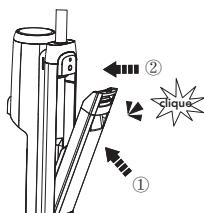
Volte a colocar o depósito no aparelho. Deverá ouvir um "clique" se colocado corretamente.
