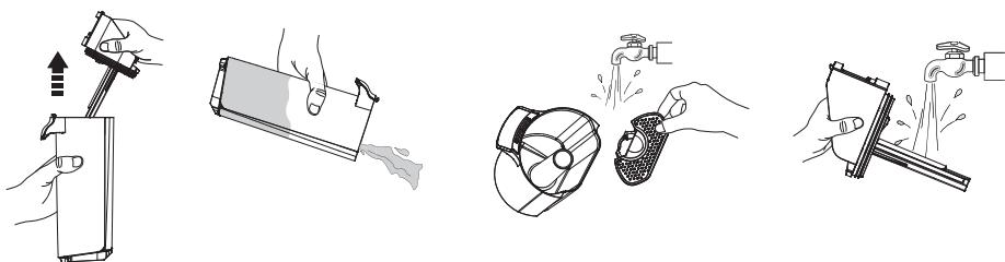
Se il coperchio del serbatoio dell'acqua sporca e il filtro all'interno sono stati ostruiti, rimuovere il coperchio del serbatoio e il filtro e sciacquare entrambe le parti con acqua.
