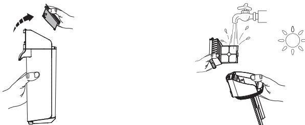
Pak het verzonken gedeelte aan elke kant van het droogfilter vast en trek het omhoog. Spoel af onder stromend water en moet volledig droog zijn alvorens opnieuw te combineren met het deksel van de DWT.
