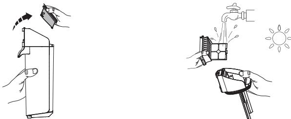
Saisissez les zones en creux de chaque côté du filtre sec et tirez vers le haut. Rincez sous l'eau courante et laissez sécher complètement avant de replacer le filtre sec dans le couvercle du RES.
