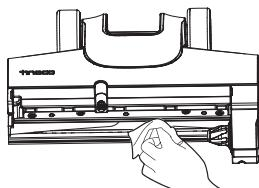
Retirez les cheveux et les débris du compartiment du rouleau brosse et de l'ouverture à l'aide d'une lingette ou d'un chiffon humide.
