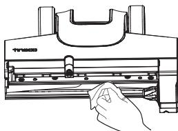
При помощи салфетки или влажной ткани удалите волосы и мусор из отсека для роликовой щетки и отверстия.
