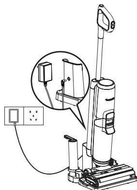
Per caricare l'apparecchio, posizionare l'apparecchio sulla base di ricarica e collegare l'adattatore a una presa di corrente.
