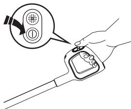
Нажмите на кнопку ①, и устройство по умолчанию начнет работу в режиме AUTO. Нажмите на нее еще раз, чтобы выключить устройство. Для переключения между режимами AUTO, MAX и ВСАСЫВАНИЕ нажмите на кнопку ⚫●●.
