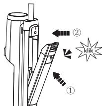
Plaats de tank terug in het apparaat. U zou een "klik" moeten horen als dit correct is gedaan.
