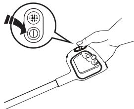
Druk op de knop 1 en het apparaat start standaard in de AUTO-modus. Druk nogmaals om het apparaat uit te schakelen. Schakel tussen de AUTO- en MAX- en ZUIG-modus door op de knop 2 te drukken.
