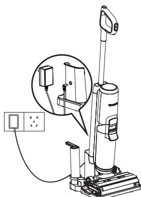
Para carregar o aparelho, coloque o aparelho na base de carregamento e ligue o adaptador a uma tomada elétrica.
