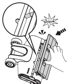
Ao substituir, fixe sempre a tampa da escova no lugar para evitar vazamentos.
