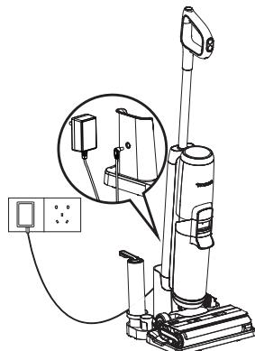
Om het apparaat op te laden, plaatst u het apparaat op het oplaadstation en steekt u de adapter in een stopcontact.
