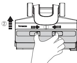
Зажмите защелки на крышке и потяните вверх для снятия.
