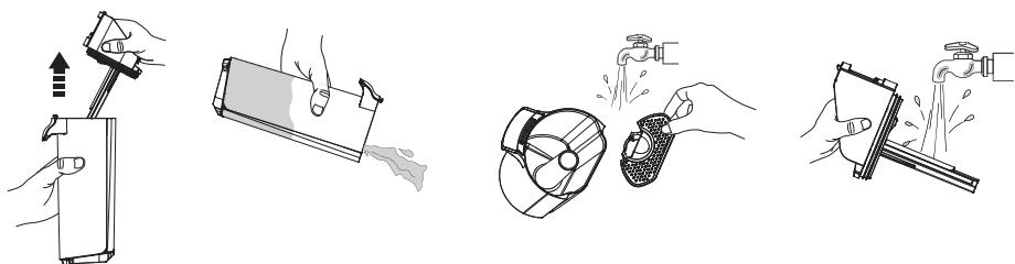
Als het deksel van de vuilwatertank en het filter binnenin verstopt zijn, verwijdert u het deksel van de tank en het filter en spoelt u beide delen af met water.
