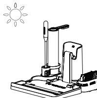
À l'aide de l'outil de nettoyage, retirez les cheveux et les débris enroulés autour du rouleau et rincez-le à l'eau. Replacez le rouleau brosse dans le porte-accessoires et laissez-le sécher complètement avant de le réinstaller.
