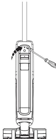
Чтобы установить ручку, вставьте ее в корпус устройства до щелчка.
