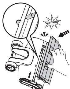
Во избежание протечек следите за тем, чтобы при установке крышка щетки фиксировалась со щелчком.
