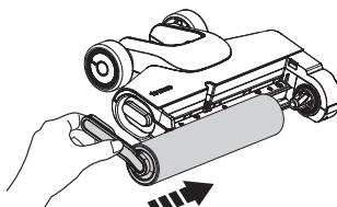
Sostituire il rullo della spazzola inserendone l'estremità nel lato destro del supporto, quindi attaccare la linguetta del rullo alla fibbia magnetica sul lato sinistro per bloccarlo in posizione.
