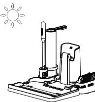
Remova detritos e cabelos enrolados no rolo com a ferramenta de limpeza e lave-o com água. Volte a colocar o rolo da escova no suporte acessório e deixe-o secar completamente antes de o reinstalar.
