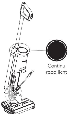
Wanneer de LED-lus rood oplicht, verwijdert u de vuilwatertank en reinigt u de vuilsensor met een vochtige doek of het reinigingsgereedschap.
