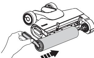
Установите роликовую щетку на место, вставив ее сначала в правую часть насадки, а затем зафиксируйте роликовую щетку магнитным креплением с левой стороны.
