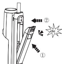
Riposizionare il serbatoio nell'apparecchio. Quando l'operazione viene eseguita correttamente, si sente un "clic".
