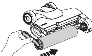
Substitua o rolo da escova inserindo a extremidade do rolo no lado direito do suporte, em seguida fixe a patilha do rolo no fecho magnético do lado esquerdo para encaixar no lugar.
