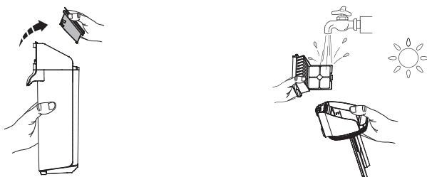
Извлеките сухой фильтр, потянув его вверх за углубления с каждой стороны. Прежде чем вставлять элементы обратно в крышку резервуара для грязной воды, промойте их под проточной водой и дайте им полностью высохнуть.
