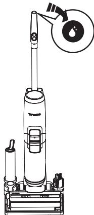
1. Placez l'appareil sur la base de recharge après l'utilisation, le capteur détecte automatiquement le niveau de saleté.
