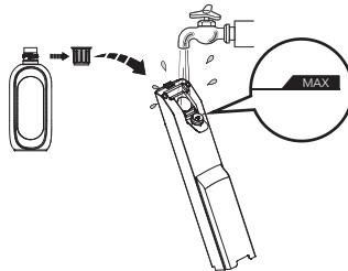
Aprire il coperchio del serbatoio e riempire con acqua corrente fino alla linea MAX. Quando è necessaria una pulizia profonda, aggiungere un tappo del flacone della soluzione nel serbatoio dell'acqua pulita e chiudere saldamente il coperchio.
